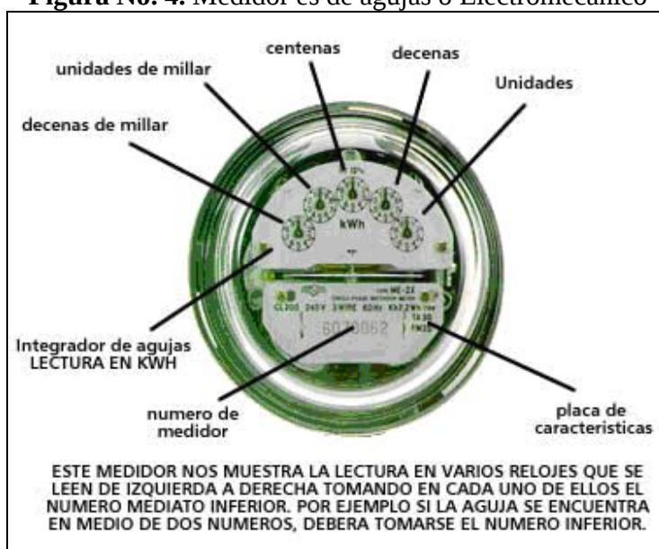
Figura No. 4. Medidor es de agujas o Electromecánico
