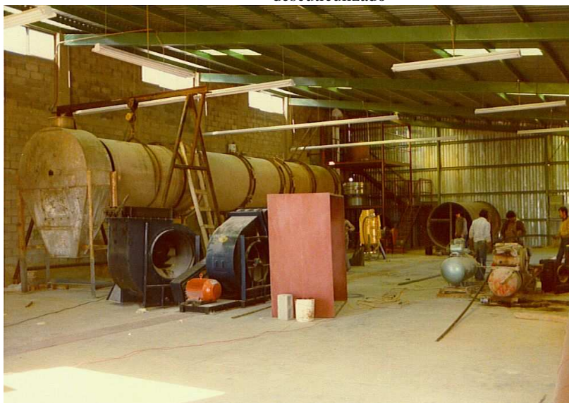
Figura 5. Secador rotatorio de acero inoxidable para el secado de ajonjolí descorticado
