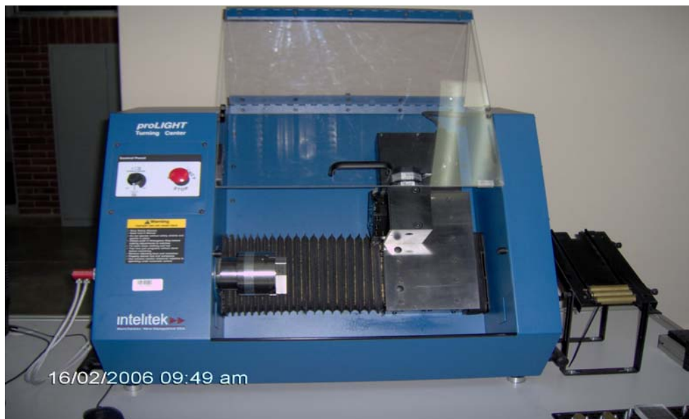
Figura No. 29. Torno CNC, Vista en la que podemos observar el dado porta herramientas y el cabezal
