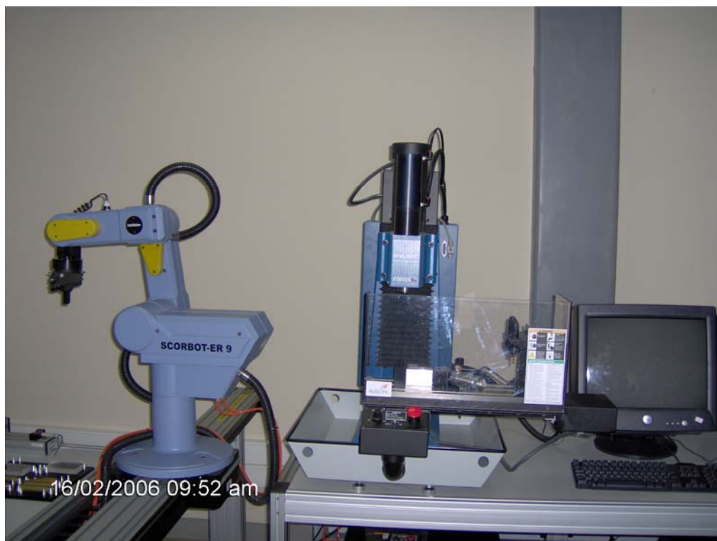
Figura No. 37. Aquí podemos observar el brazo robot, junto a la Fresadora CNC y su respectivo ordenador de control y programación.
