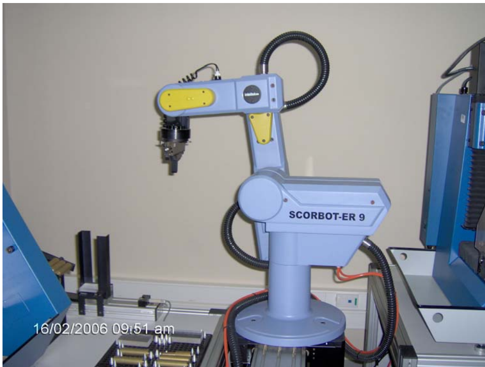
Figura No. 34. En esta toma podemos apreciar el brazo robotizado, que como lo indicamos anteriormente, cumple la función de transporte de material y alimentación para las dos estaciones de maquinado, el torno y la fresa CNC.
