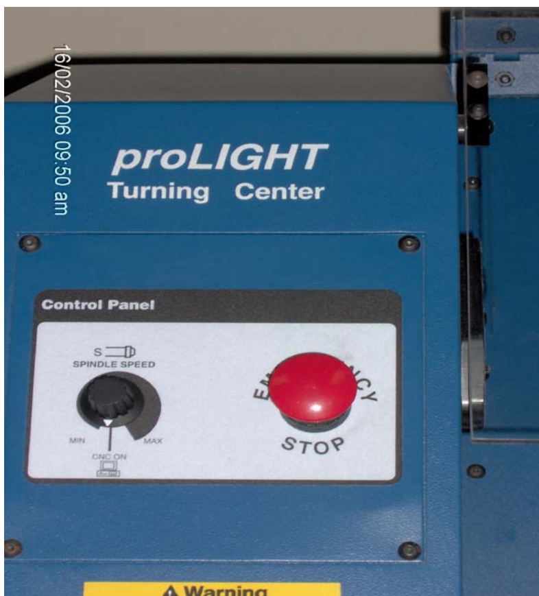
Figura No. 32. En esta toma podemos apreciar el control de mando de paro de emergencia, y un ajuste de velocidad, Torno CNC
