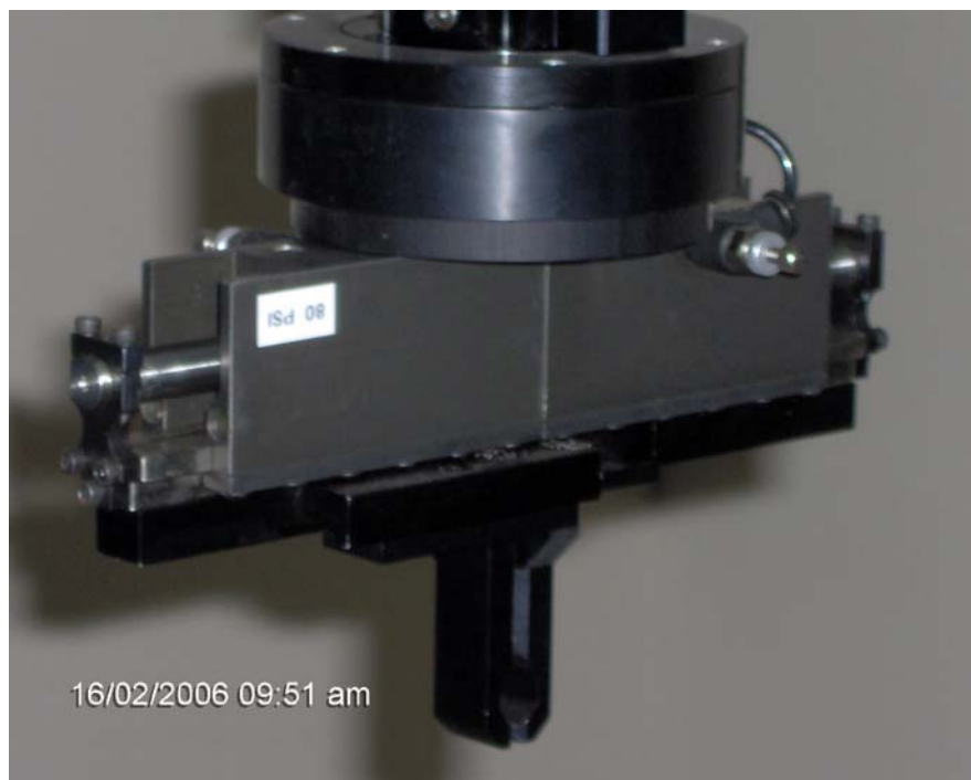
Figura No. 35. Aquí tenemos un acercamiento a lo que es el Gripper del brazo robot, en este caso se esta utilizando un actuador neumático.
