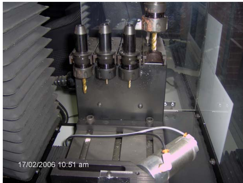
Figura 40. En esta figura podemos apreciar la estación de herramientas y la fresa sosteniendo una fresa lista para operar.
